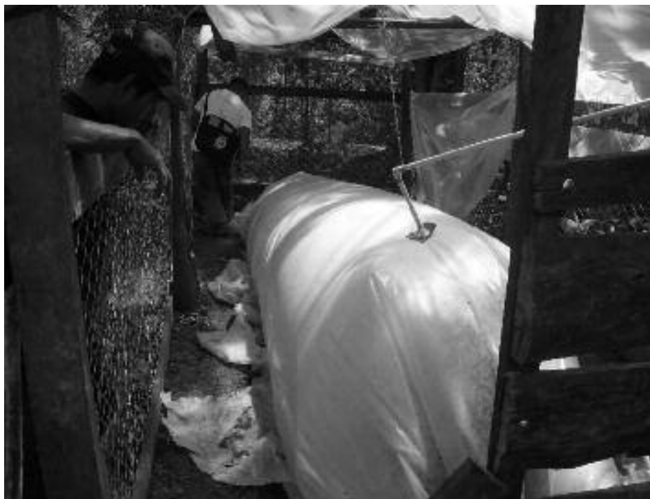
Biodigestor cargado en el departamento de Jinotega (Nicaragua).
