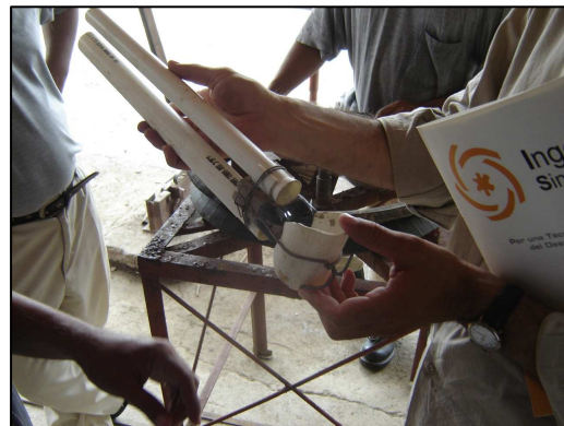
Detalle de la pieza inferior de la bomba de mecate en la Fundación para el Desarrollo Social y Económico del Área Rural, DESEAR, en Los Cedros, Nicaragua. Fotografía cortesía de Gabriel Rebassa
